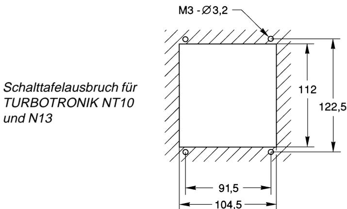
Fig. 4 Maßzeichnungen der TURBOTRONIK NT10, NT12, NT13
