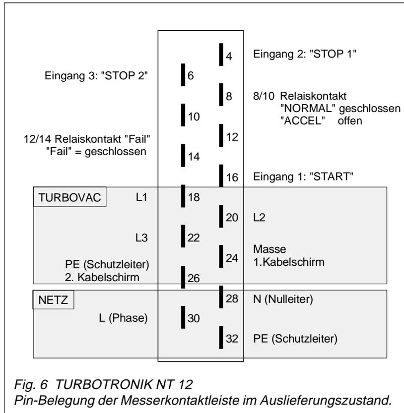
Im Auslieferungszustand der TURBOTRONIK NT 12 sind 3 Betriebsarten durch Beschaltung der Steuereingänge Pin 4, 6 und 16 der Messerkontaktleiste möglich.
