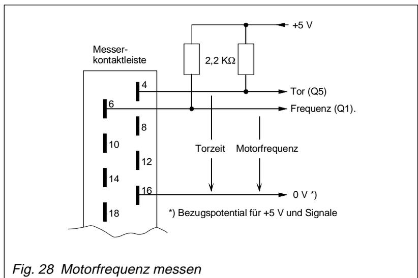
Fig. 28 Motorfrequenz messen
