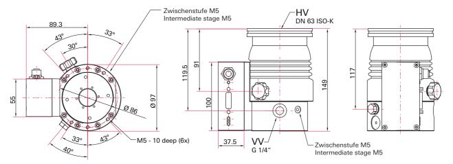
Fig. 18: SplitFlow 50, DN 63 ISO-K
