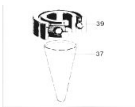
Fig. 29 Rillenkugellager 39 Deep groove ball bearing 39 Roulement rainuré à billes 39
