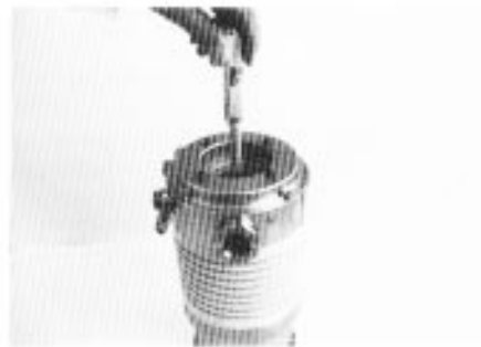
Fig. 32 Spritzmutter 37 anziehen Tighten splash nut 37 Serrer l'écrou de barbotage 37
