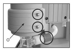
**PC 3001 VARIO**<sup>pro</sup> / **PC 3001 VARIO**<sup>pro</sup> **IK** Disassemble the exhaust vapor condenser.
